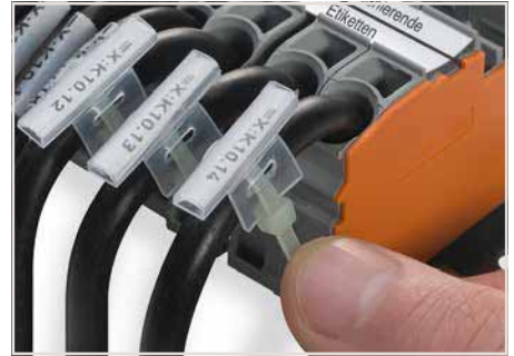
Kennzeichnungsstülpe (211-829) durch Kabelbinder an Einzelader oder Kabel befestigen.
